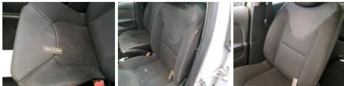
Revêtement assise siège AVG, Déchirure, E - Remplacer
